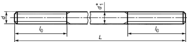
Рисунок 2 - Конструкция и размеры шпилек, лист 1
